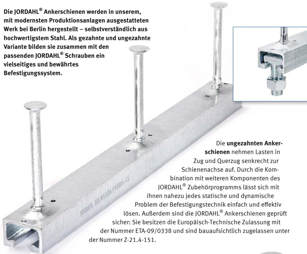
Die **ungezahnten Ankerschienen** nehmen Lasten in Zug und Querzug senkrecht zur Schienenachse auf. Durch die Kombination mit weiteren Komponenten des JORDAHL® Zubehörprogramms lässt sich mit ihnen nahezu jedes statische und dynamische Problem der Befestigungstechnik einfach und effektiv lösen. Außerdem sind die JORDAHL® Ankerschienen geprüft sicher: Sie besitzen die Europäisch-Technische Zulassung mit der Nummer ETA-09/0338 und sind bauaufsichtlich zugelassen unter der Nummer Z-21.4-151.
