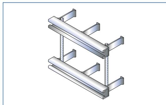
Ankerschienenpaar zur Oberleitungsbefestigung in Bahntunneln
